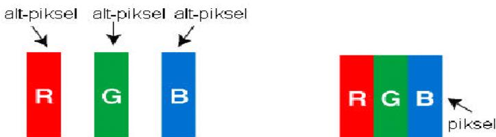
Üretim teknolojileri gereği söz konusu alt-pikseller sürekli yanık ya da sürekli olarak sönükle kalmak şeklinde “alt-piksel hatasına” neden olabilirler.
