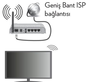
Bant genişliğini artırmak için aynı anda 2.4 ve 5 GHz bantlarına sahip bir Kablosuz-N router (IEEE 802.11a/b/g/n) tasarlanmıştır. Daha düzgün ve hızlı HD video akışı dosya transferleri ve kablosuz oyunlar için optimize edilmiştir.
