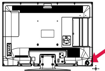
Kontrol Kolu, TV'nizin Ses / Program / Kaynak ve Bekleme fonksiyonlarını kontrol edebilmenize olanak sağlar.
